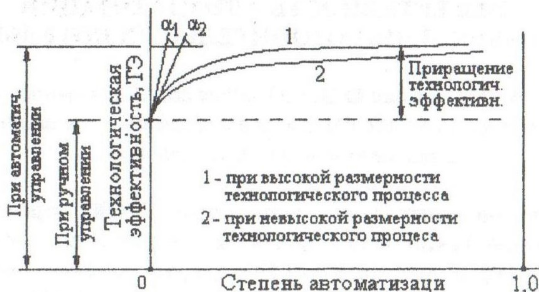
Рис.1. Влияние степени автоматизации ПOK на ее технологическую эффективность
