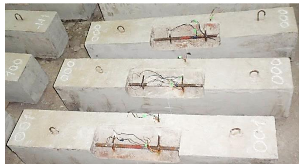
Рис. 2.12. Дослідні зразки колон
