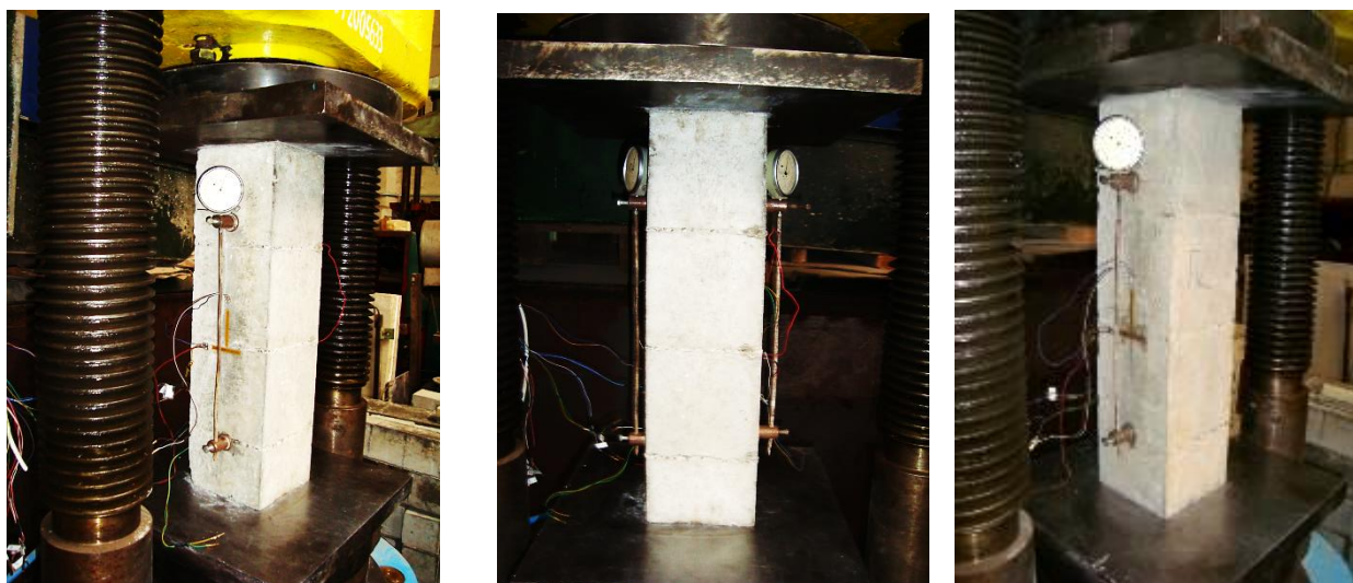
Рис. 3.21. Випробування бетонних призм
