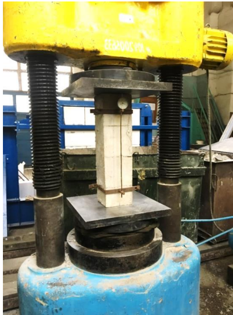
Рис. 2.13. Визначення призової міцності бетону
