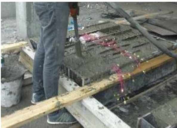
Рис. 2.10. Бетонування дослідних залізобетонних колон
