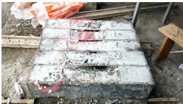
Рис. 2.12. Дослідні зразки колон
