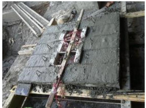
Рис. 2.10. Бетонування дослідних залізобетонних колон
