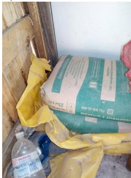
Рис. 2. Зберігання другої партії цементу в холодній прибудові
