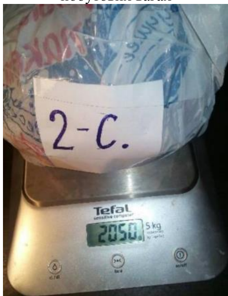
Рис. 7. Зважування зразка цементу 2-С на побутових вагах
