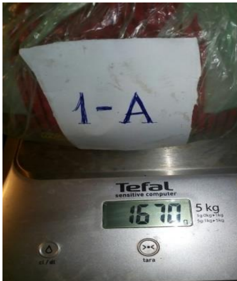
Рис. 5. Зважування зразка цементу 1-А на побутових вагах
