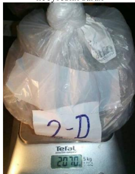
Рис. 8. Зважування зразка цементу 2-Д на побутових вагах
