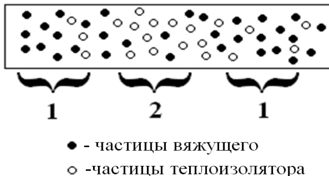
Рис. 2. Градієнтна структура теплоізоляційного матеріалу:
