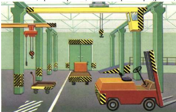
Рис. 3. Пример опознавательной окраски опасных зон и предметов.
