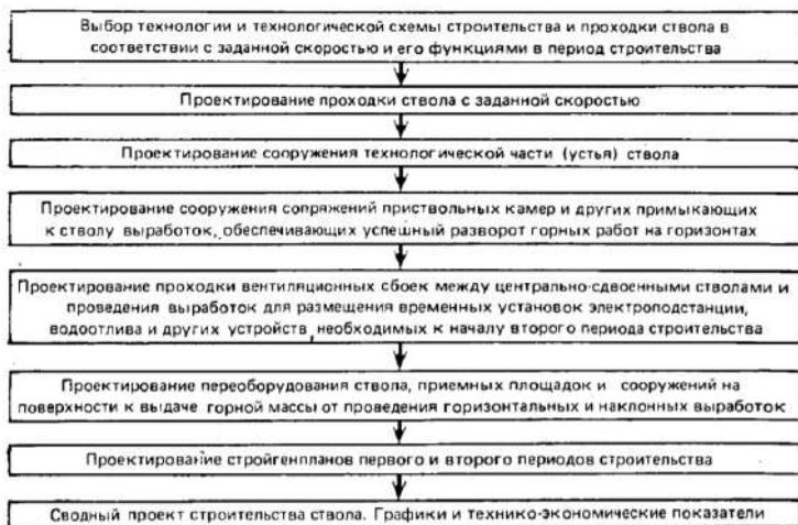
Рис. 3. Порядок проектирования строительства стволов шахт.
