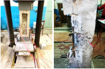
Рис. 8. Дослідні колони до та після випробувань
