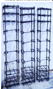
Рис. 3. Каркаси дослідних колон
