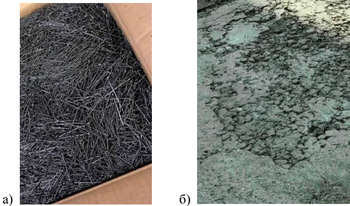
Рис. 1. Сталева фібра а – до застосування; б – у готовому виробі
