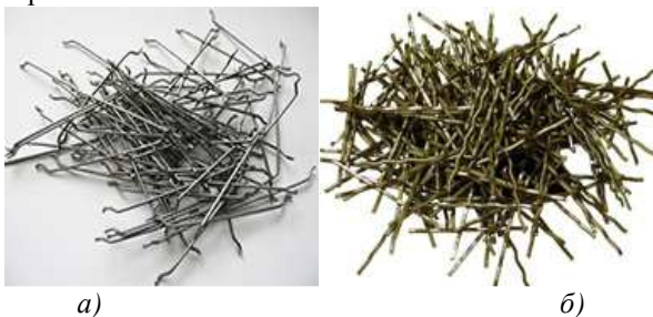
Рис.1. Основные виды стальной фибры: а) анкерная; б) волновая.
