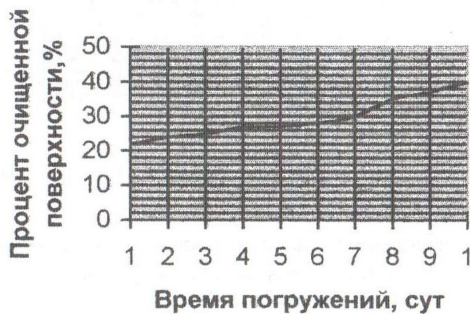
Рис. 6. Исследование растворения в реактивном топливе отложений внутренней поверхности образца 3, при температуре растворителя t_{pt} = 30^{\circ}C .
