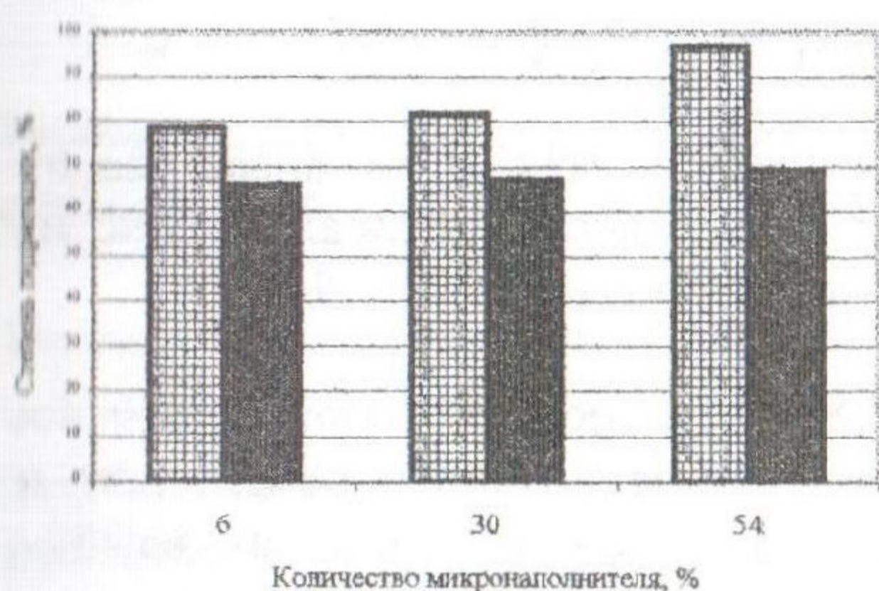
Рис.2. Влияние количества наполнителя на степень гидратации механоактивированных цементно-водных композиций на 28-е сутки твердения при S_{уд} = 100 \text{ м}^2/\text{кг} .
