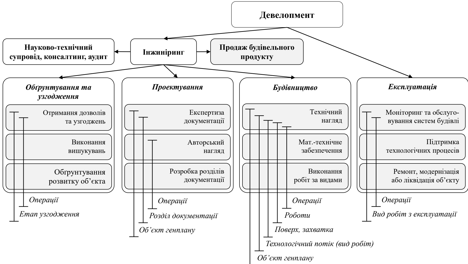
Рисунок 5.4 – Класифікація можливих предметів угод в будівництві та їхня ієрархічна деталізація (примітка: наявність вертикальної риски в блоці означає можливість укладання договірних відносин за відповідним ієрархічним рівнем)
