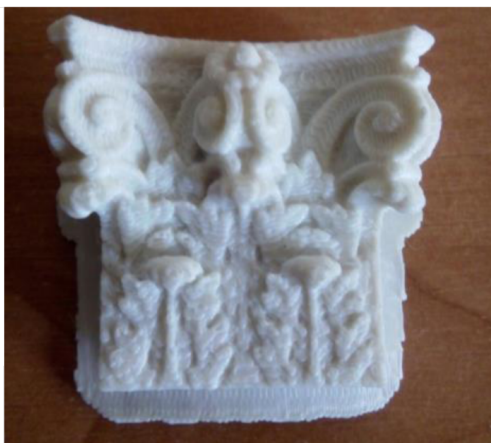
Рис.1. 3D модель барельєфу воріт Флорентійського баптистерію. Виготовлена на 3D принтері компанії Prototek Італія.
