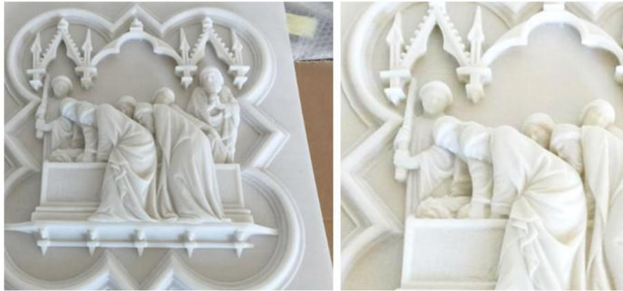
Рис.1. 3D модель барельєфу воріт Флорентійського баптистерію. Виготовлена на 3D принтері компанії Prototek Італія.
