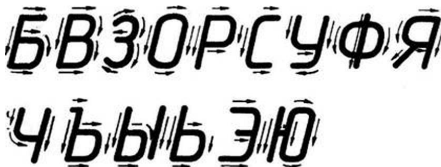
Рис.1.7а. Креслення заголовних літер, що складаються з прямолінійних і криволінійних елементів
