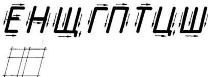
Рис. 1.6. Креслення заголовних літер, що складаються з горизонтальних і вертикальних елементів
