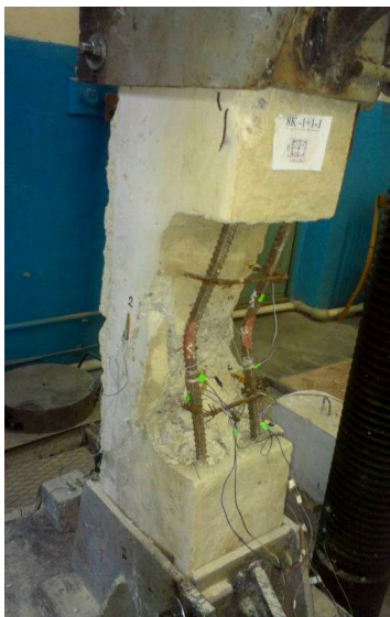
Рис. 4. Потеря устойчивости сжатой арматуры
