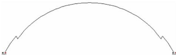
Рис. 2. Деформации арки в предельном состоянии
