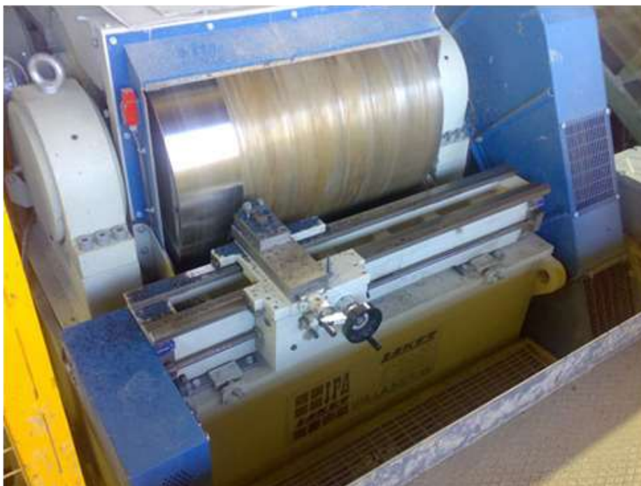
Рис. 4.2.6.1.2. Токарна обробка вальця на плющильному верстаті.
