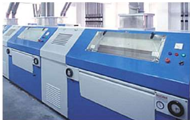
Рис. 2.2.3.2.1.15. Схема (а) і загальний вид (б) вальцевого верстата.
