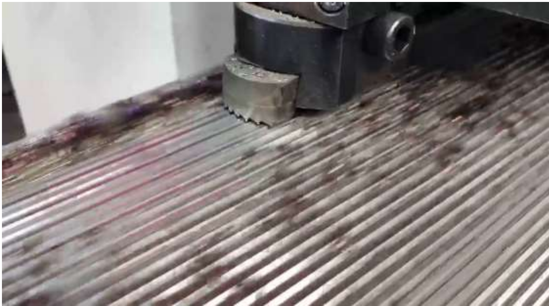
Рис. 2.3.6.7. Конструкція різця для нарізання поверхні вальця.
