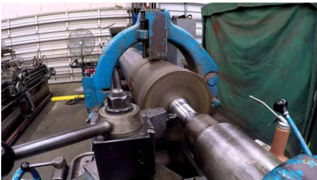
Рис. 2.3.6.8. Відновлення кінчної поверхні під підшипник.
