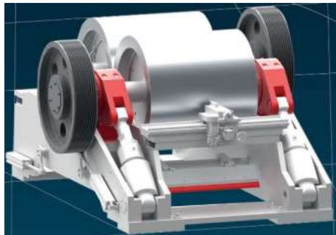
Рис. 3.2.5.10. Загальний вид дробарки зі знятим кожухом.
