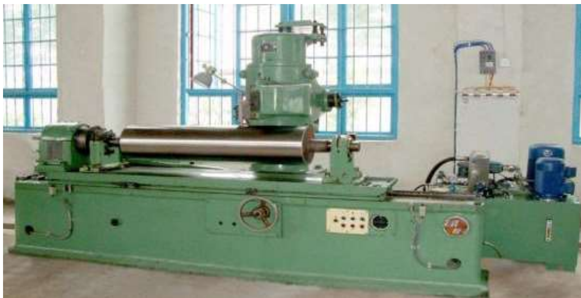
Рис. 2.3.6.6. Конструкція верстата для шліфування та нарізання вальців.
