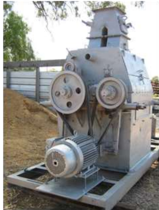
Рис. 2.2.3.2.1.14. Схема (а) і загальний вид (б) вальцевого верстата.
