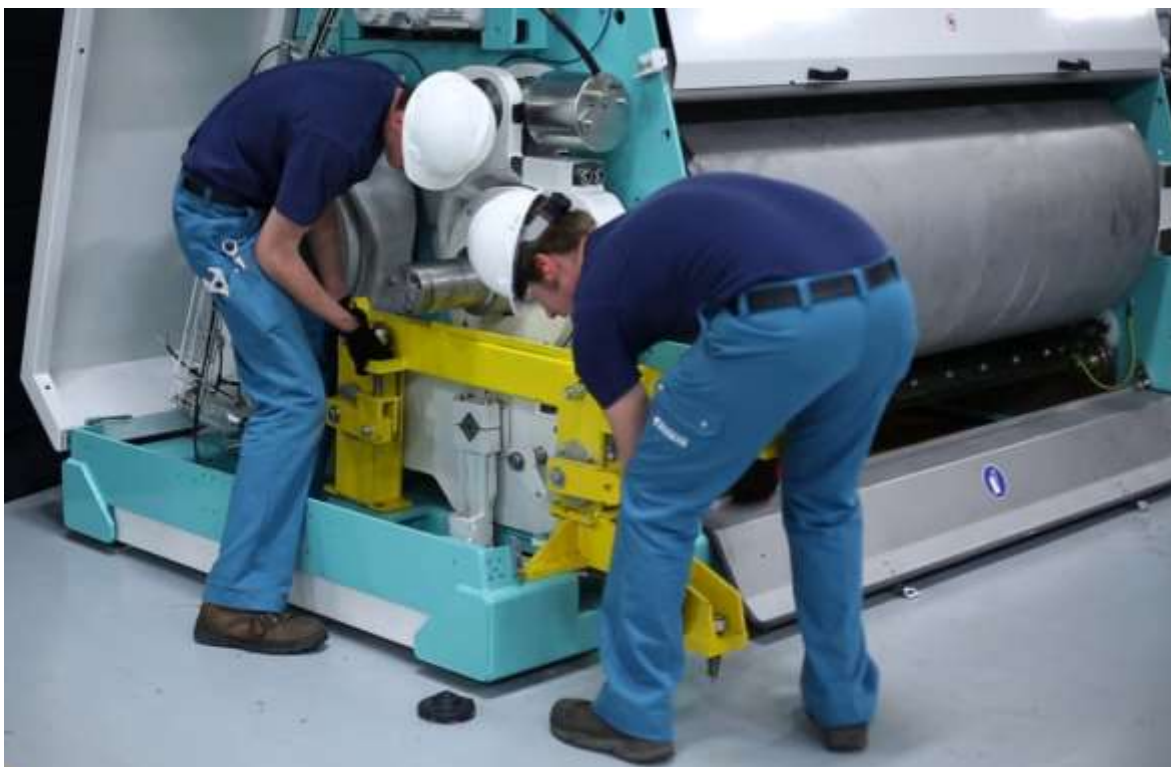
Рис. 4.2.6.1.1. Зняття вальця з плющильного верстата.
