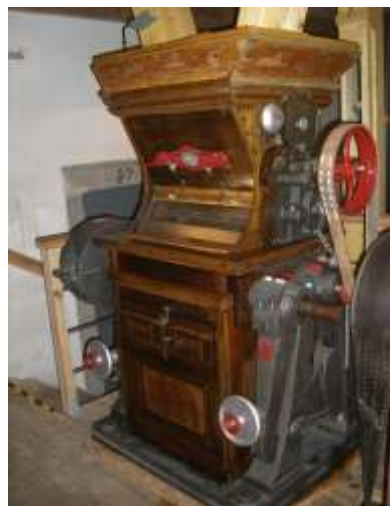
Рис. 2.2.3.2.1.1. Схема і загальний вигляд вальцювого верстата з установчим механізмом у вигляді важелів першого роду.
