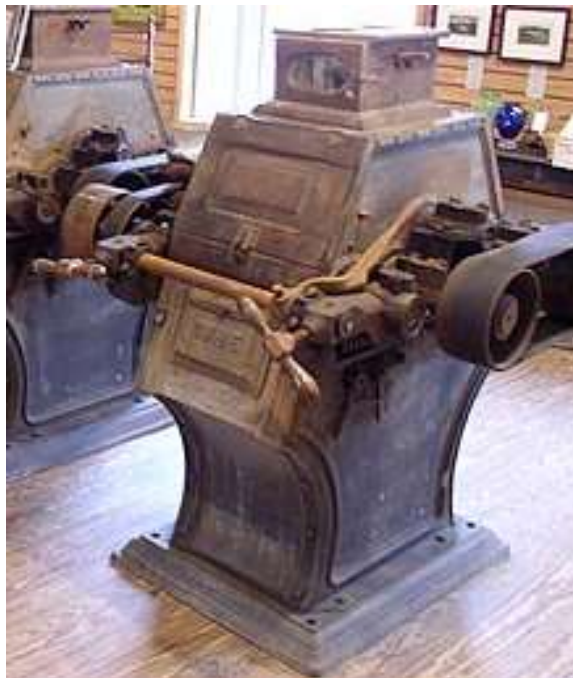
Рис. 2.2.3.1.1.4. Вальцьовий верстат з ексцентровим валом.
