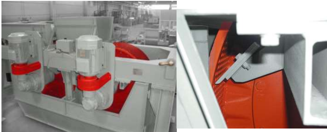
Рис. 3.2.5.17. Загальний вид а) та внутрішній скребок дробарки.
