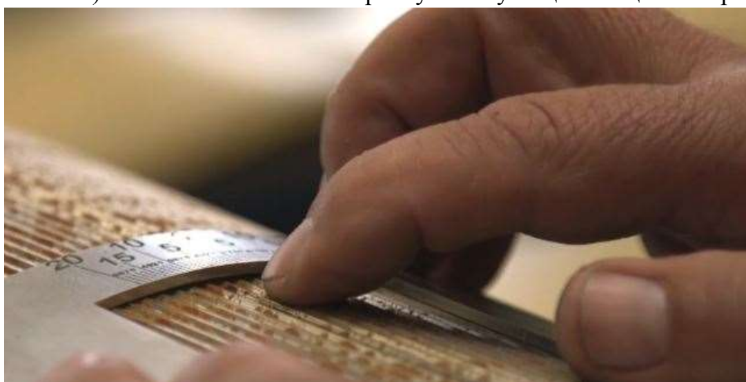
Рис.2.2.2.11. Пристосування для визначення рифлів вальця.
