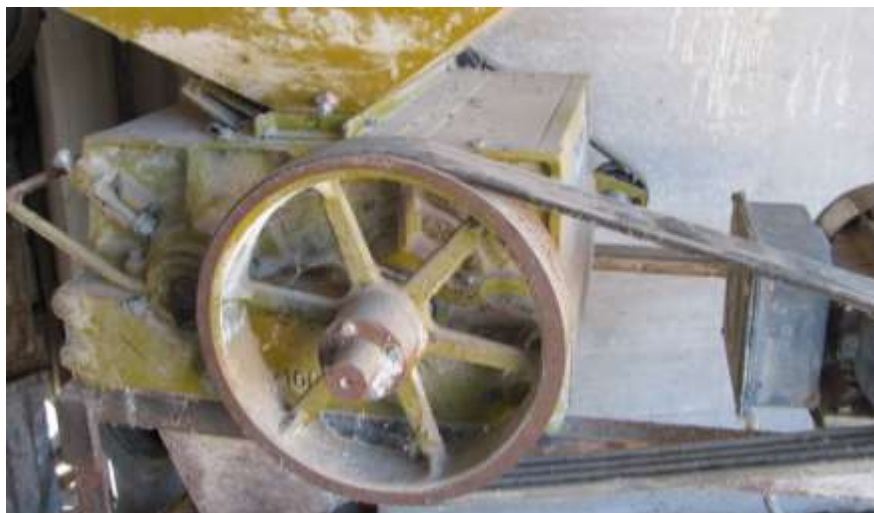
Рис. 3.2.3.1.2. Вальцева дробарка з регульованими ексцентриками фірми УМТ.
