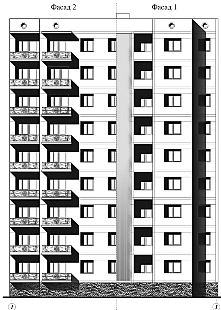
Рис. 3.13-1. Архитектурные решения совмещенных фасадов здания А
