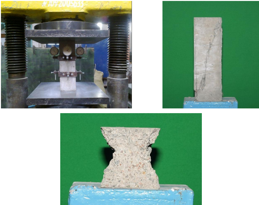
Рис. 2.5 Схеми випробування та характер руйнування бетонних призм і кубів
