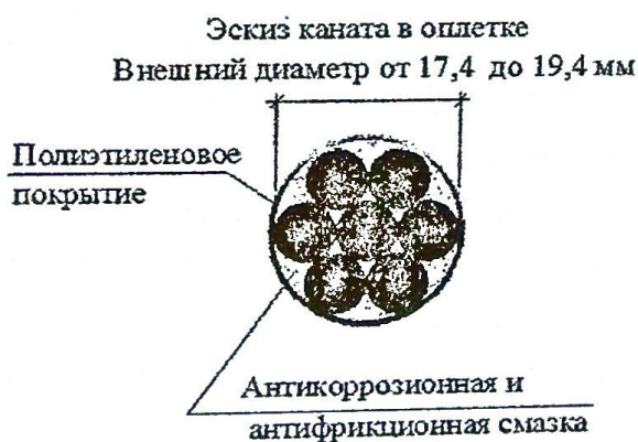
Рис. 3. Сечение каналобразователя и арматурного каната
