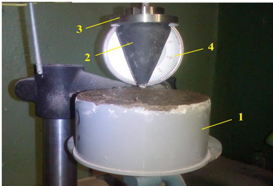
Рис. 1. Испытание раствора на пластометре Ребиндера: 1 – форма с исследуемым раствором; 2 – конус; 3 – пригруз для конуса; 4 – индикатор погружения конуса
