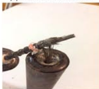
Рис. 3 Образец базальтовой арматуры после испытания.
