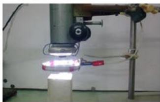
Рис.2. Установка для мікрофотографування зразків
