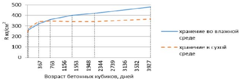
Рис. 1 Нарастание прочности бетона во времени по данным, приведенным в [1]
