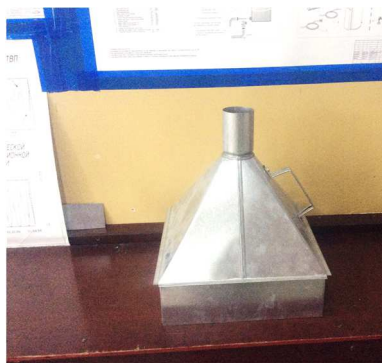
Зонт для замера скорости истечения воздуха от анемостата
