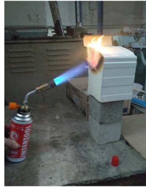
Рис. 2. Испытание на огнестойкость
