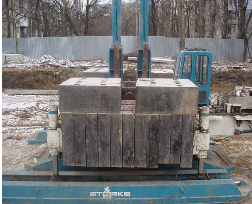
Рис. 2 Машина для вдавлювання паль Starke 180
