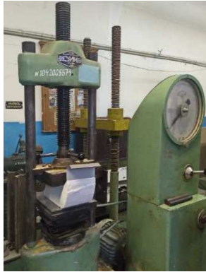
Рис. 1. Испытание на сжатие
