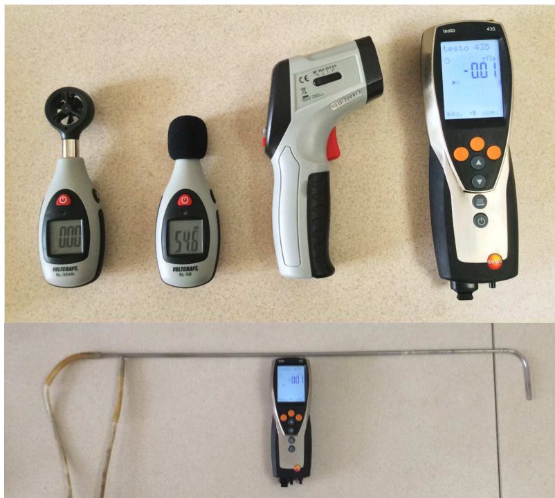
Рис. 5. Инструментарий, используемый при измерениях и наладке системы
