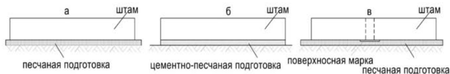
Рис. 3. Схемы монтирования штампа по ГОСТ (а); по Абелеву Ю.М.
