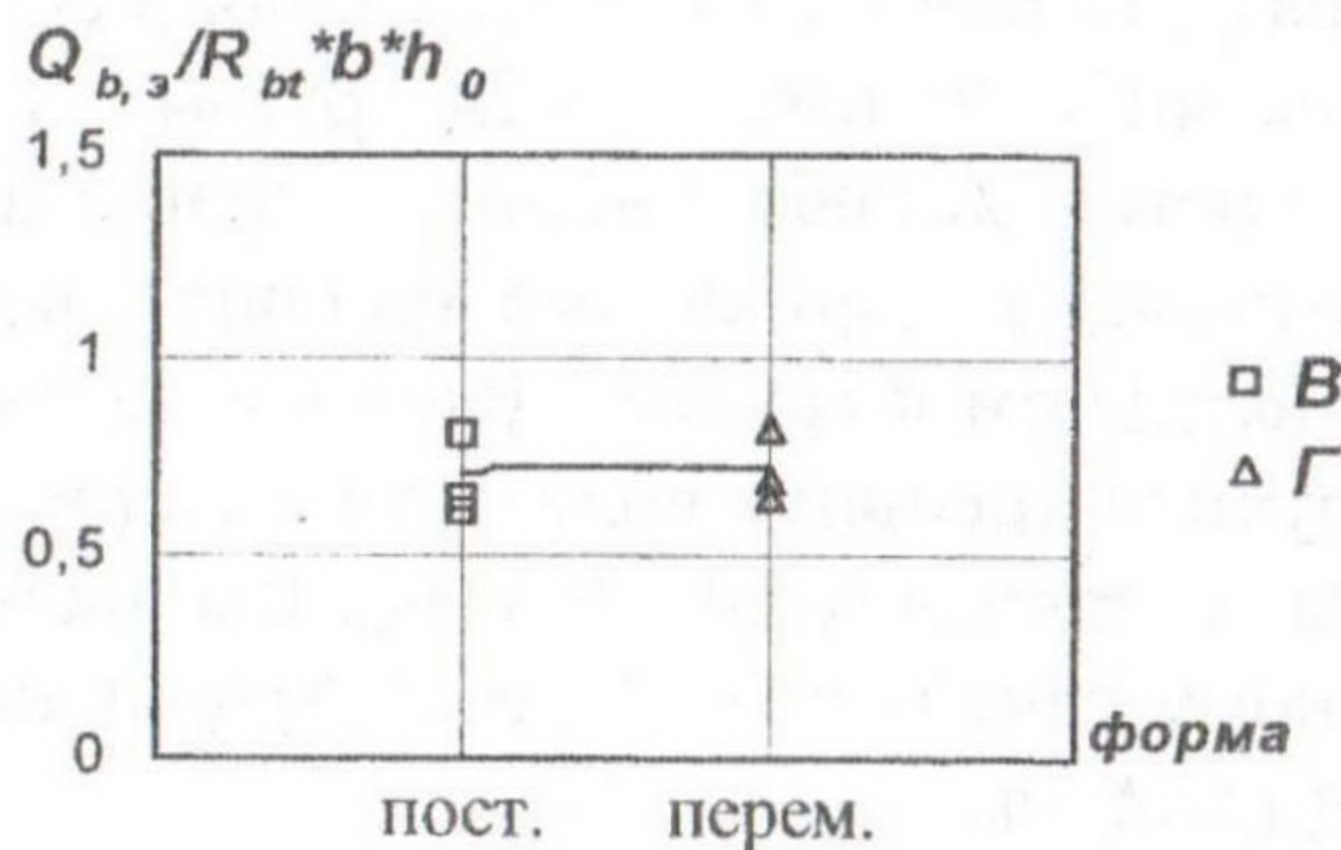
Рис. 3. Влияние формы поперечного сечения балок на величину относительной несущей способности бетона.
