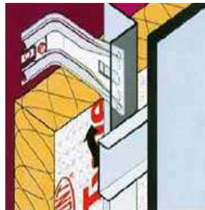
Рис. 5.22. Невидимое крепление натурального камня
