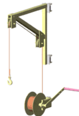
Рис. П.3.7. Лебедка ручная Грузоподъемность - 30 кг
