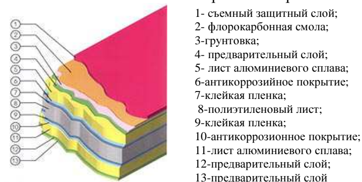
Рис. 4.30. Структура композитной панели Алюкобонд
