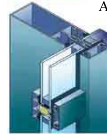
Рис. 6.5. «Теплые» алюминиевые профили (НУЕСК) с теплоизоляционной вставкой.
