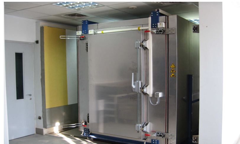
Рис. П.4.1. Аппарат искусственной погоды Weiss WK 10/40-90
