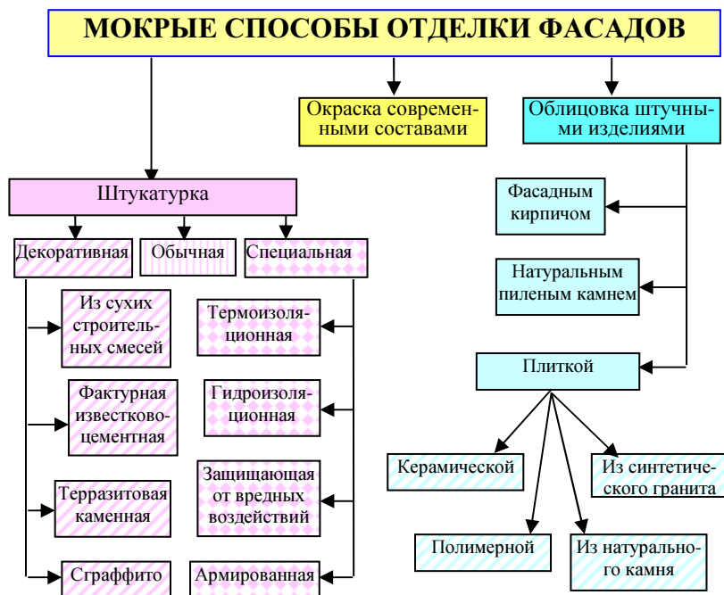
Рис. 2.1. Классификация применяемых «мокрых» способов отделки фасадов.
