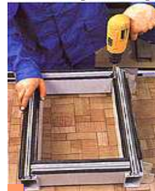
Рис. 6.22. Крепление ригеля к стоечному профилю
