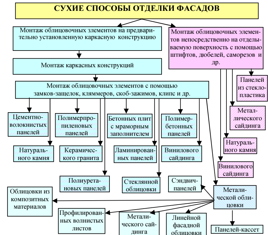
Рис. 3.1. Классификация сухих способов отделки фасадов
