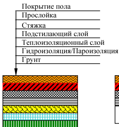
Рис.1. Вариант конструкции пола на грунте
