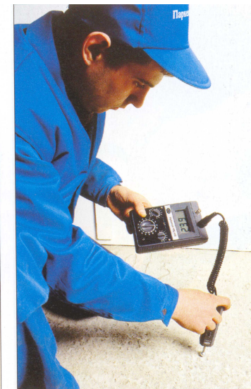
Рис.5.9. Измерение влажности основания влагомером
