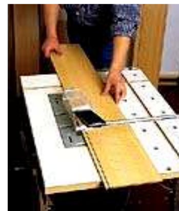
Рис.5.40. Разрежьте планку по разметке, лучше всего закрепленной на станине циркулярной пилой (стационарной или портативной). Если это невозможно, воспользуйтесь электролобзиком или ручной ножовкой с мелкими зубьями.
