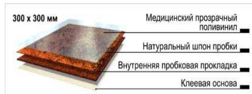
Рис.5.46. Структура пробкового покрытия
