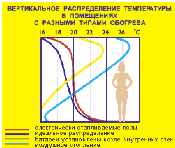
Рис.7.1. Распределение температур в помещениях с различными типами обогрева
