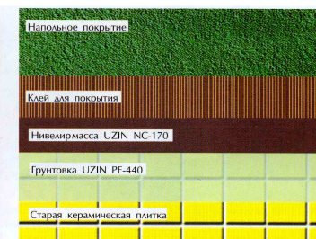
Рис.2.30. Укладка покрытий на непитываемые основания
