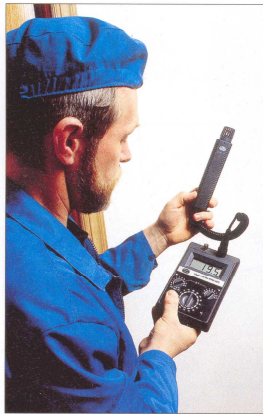
Рис.5.14. Контроль ровности, влажности основания и температуры и относительной влажности воздуха в помещении
