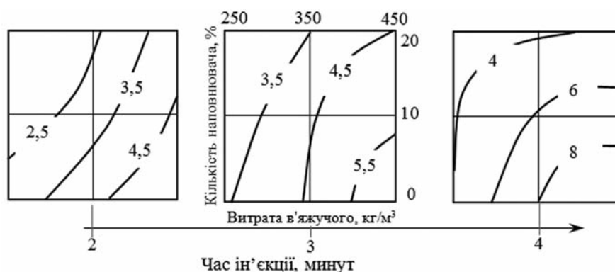
Рис. 2. Вплив часу ін'єкції на f_{sk.cube} (МПа) ґрунтобетону при тиску ін'єкції 0,5 МПа
