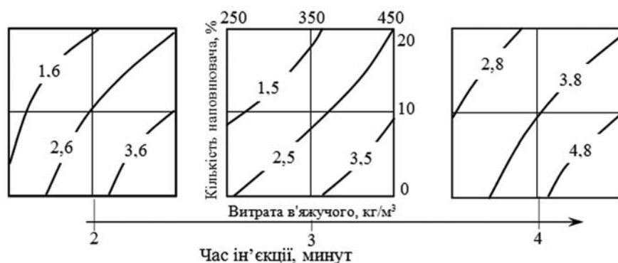
Рис. 1. Вплив часу ін'єкції на f_{sk.cube} (МПа) ґрунтобетону при тиску ін'єкції 0,1 МПа
