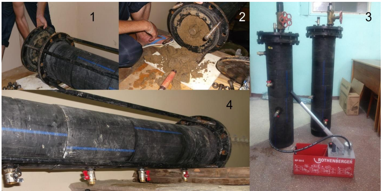
Рис.2.7. Лабораторный стенд и порядок проведения исследований технологических режимов инъецирования бентонитовым раствором:
