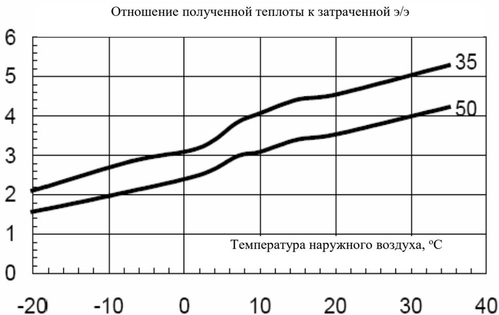
Рис.3. Отношение полученного количества тепла к затраченной электроэнергии, в зависимости от температуры окружающего воздуха и температуры нагрева (35, 50°C) для теплового насоса воздух-вода
