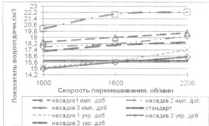
Рис. 6. Зависимость водоотдачи от вида сменного оборудования и времени перемешивания составов 5 и 9
