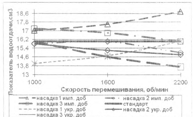
Рис. 3. Зависимость водоотдачи от вида сменного оборудования и времени перемешивания составов 2 и 3
