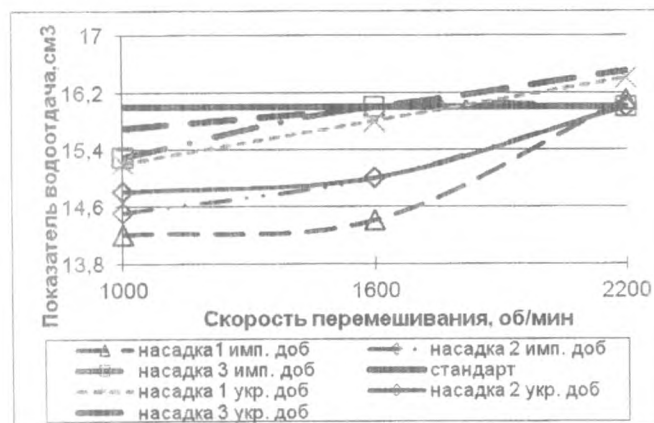
Рис. 5. Зависимость водоотдачи от вида сменного оборудования и времени перемешивания составов 4 и 8
