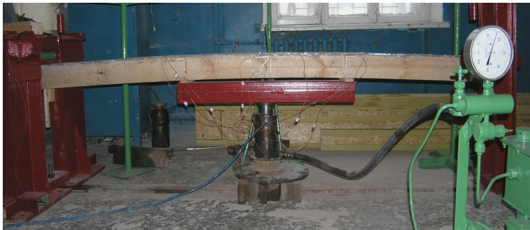
Рис. 1. Испытание балки двумя сосредоточенными силами через металлическую траверсу
