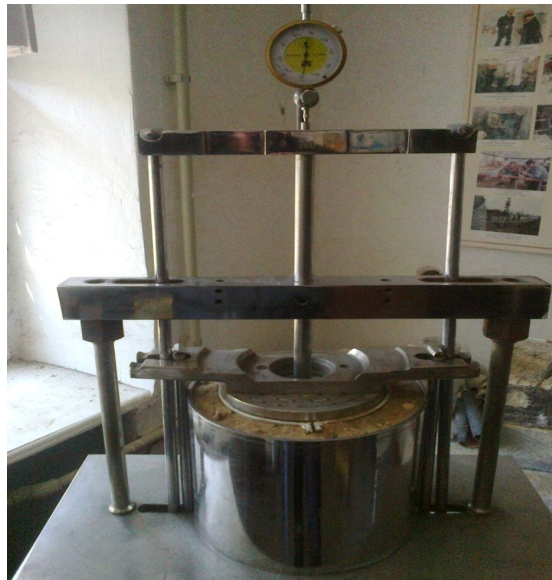
Мал. 2. Прибор ОІСІ-4 на завантажувальному столі
