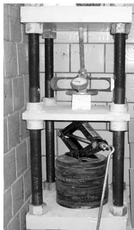
Рис. 2.3. Схема и внешний вид силовой установки для испытания на одноосное сжатие: 1 — неподвижная пластина; 2 — подвижная пластина; 3 — испытуемый образец; 4 — упорный стальной цилиндр; 5 — динамометр для измерения вертикальной нагрузки; 6 — домкрат; 7 — индикаторы часового типа
