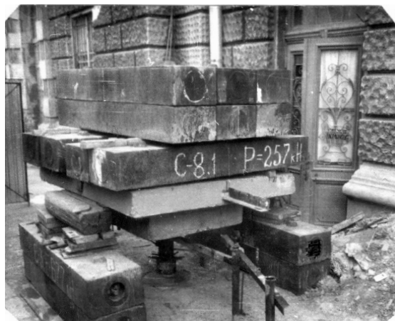
Рис. 4.13. Исследования на участке 7: а) процесс установки стойки-штампа в скважину; б) общий вид загруженных штампов; в) нагрузка на фрагмент сваи
