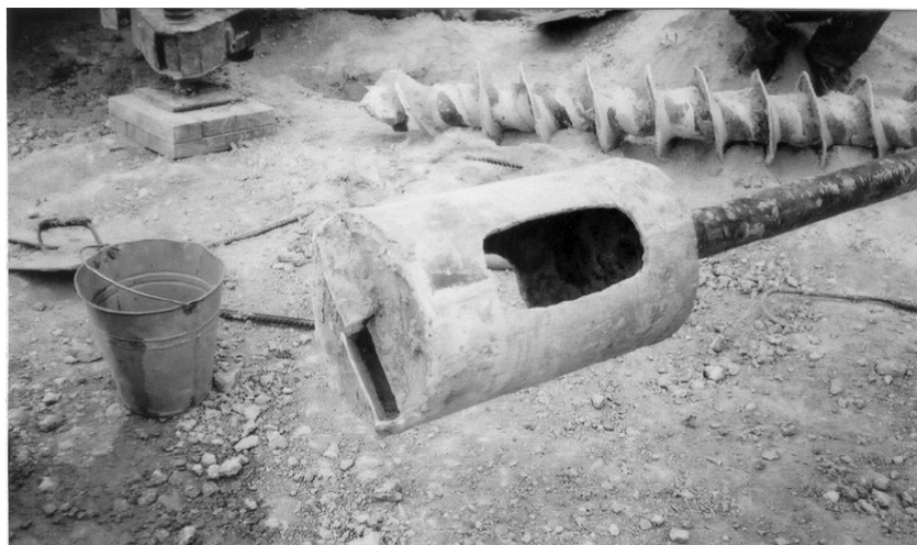
Рис. 2.8. Грунтозаборник для зачистки забоя скважин
