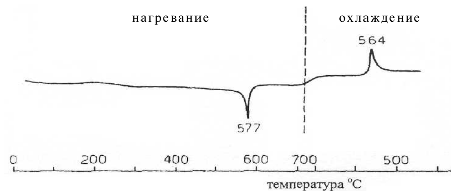
Рис. 2.15. Эндотермический эффект (во время нагрева) и экзотермический эффект (во время остывания) в кварцевом образце, тепловая инерция системы вызывает задержку появления максимальной интенсивности при охлаждении и нагреве
