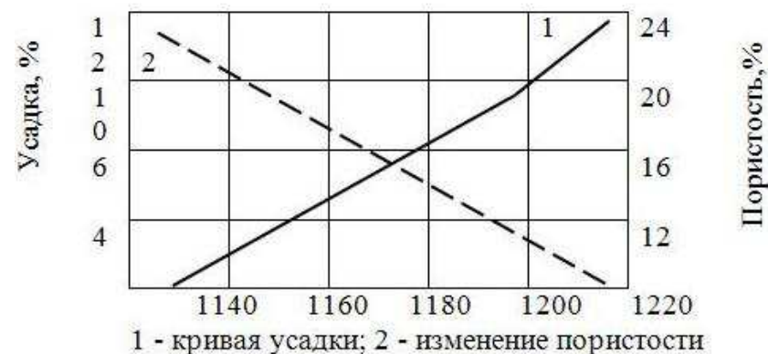
1 - кривая усадки; 2 - изменение пористости Рис. 2.70 - Кинетика усадки и уплотнения каолиновой глины Сухановского месторождения при обжиге во втором периоде
