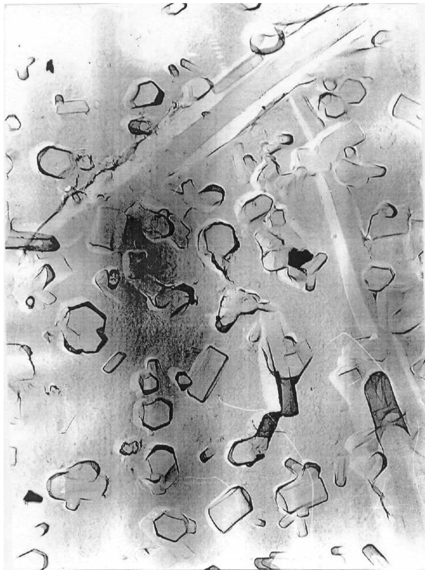
Рис. 2.94. Микроструктура муллитизированной частицы метакаолина из Алексеевского каолина. Платиноуглеродная реплика из отдельных частиц, отделение химическое, увеличение в 20000 раз
