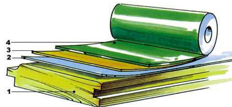
Рис. 1.23. Наборные панели фирмы HDM со специальной облицовкой поверхности по методу ELESKO: 1 - MDF; 2 - слой клея; 3 - бумага с декором; 4 - антистатичный слой с добавлением минеральных частиц (корунда)
