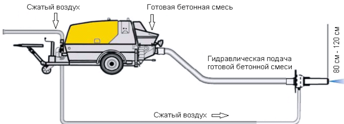
Рисунок 2. Гидравлическая подача смеси при способе мокрого торкретирования.
