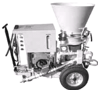
Рисунок 5. Оборудование для сухого торкретирования: а) Aliva-246.5 «базовая» версия; б) Aliva-263 «продвинутая» версия.
