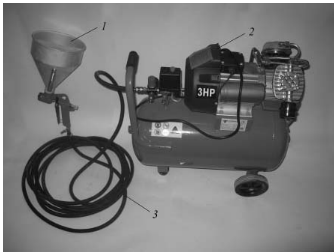
Рис. 2. Комплект технологічного обладнання, яке використовується для замоноличування стиків тонкостінних елементів огорожувальних конструкцій: 1 – бункер-пістолет; 2 – пересувний компресор; 3 – шланг повітряний
