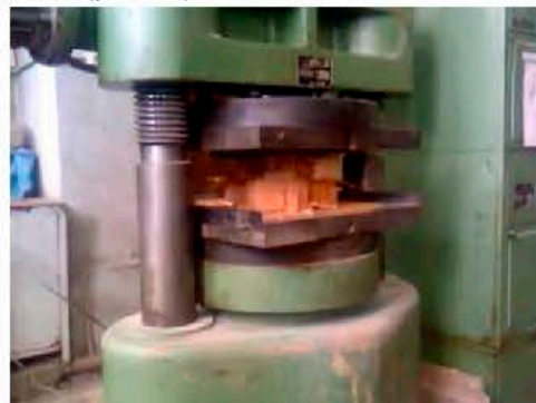
Рис. 5. Фотофрагмент проведения испытания образца на сжатие
