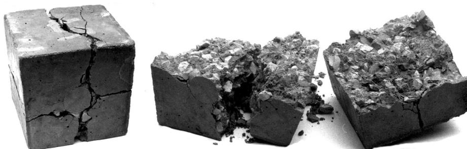
**Рис. 5.21. Вид бетонных образцов после переменного замораживания и оттаивания разрушенных при ударной нагрузке 1) гравийного бетона, 2) щебневого бетона.**
