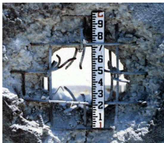
**Рис. 2.14. Исследование бетонной плиты при использовании взрывчатых веществ.**
