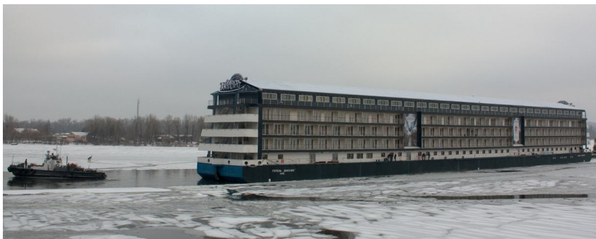
Рис.3. Плавающий железобетонный отель «Баккара» (Киев). Построен на Херсонском государственном заводе железобетонного судостроения «Паллада».
