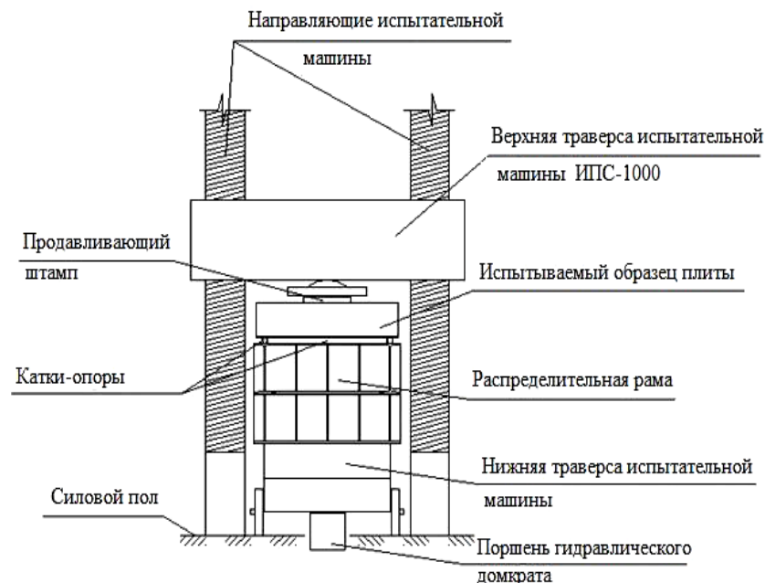
Рис. 2.3 Схема установки для испытания плит на продавливание.
