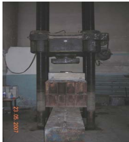
Рис.2.5 Плита, подготовленная к испытанию в установке ИПС-1000.
