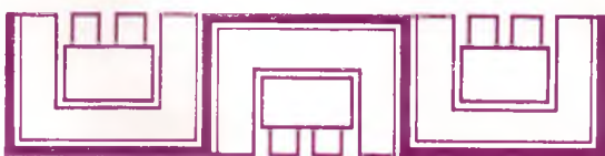
53. Приемы размещения оборудования в торговом зале: a — вдоль стены; b — в нишах; c — линейное; z — островное.
