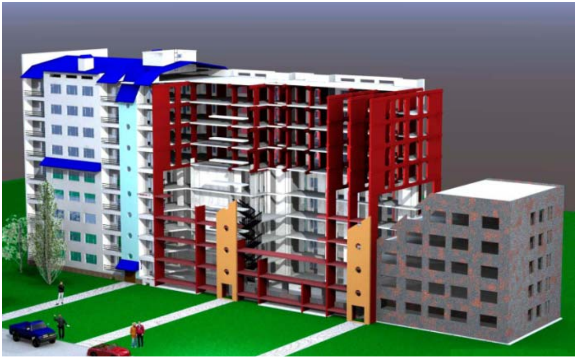
Рис.2. – Этапы проведения реконструкции здания по ул. Парковой, 75б в г. Одессе.
