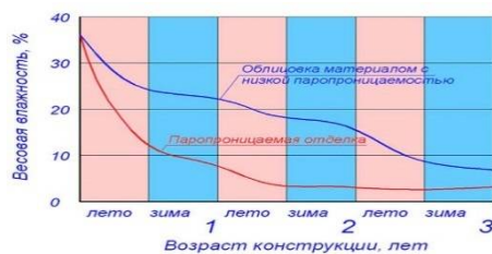
Рис. 2. Скорость высыхания стеновой конструкции в зависимости от паропроницаемости наружного декоративно-защитного покрытия
