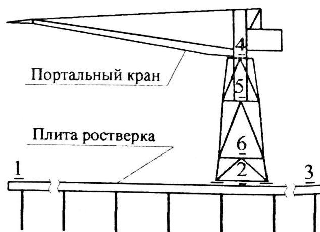
Рис. 1. Схема расположения датчиков на плите ростверка (1, 2, 3) и портальном кране (4, 5, 6) соответственно на отметках 7.5, 20.0, 31.5 м.
