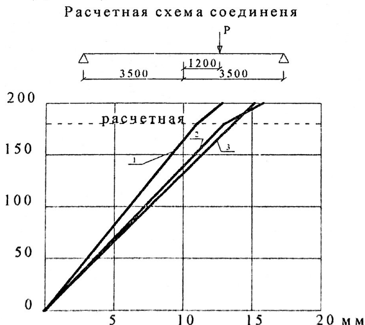
Рис.3. Прогиб в середине клеестоющей балки.
