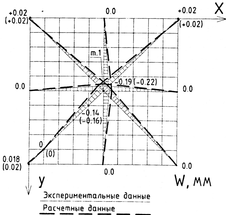
Рис. 4. Прогибы в оболочке при загрузении в точке 1.
