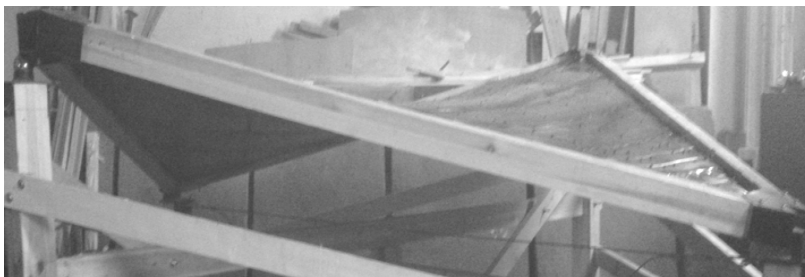
Рис. 5. Вид с боку оболочки из параболических панелей размером 3000x3000x35мм в лаборатории кафедры МДиПК ОГАСА.
